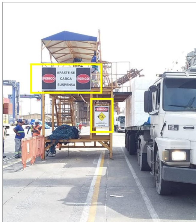
Figura 4 - Ilustração de sinalização de segurança nas plataformas de trabalho em altura, com os dizeres: PERIGO, AFASTE-SE CARGA SUSPENSA e AFASTE-SE MOVIMENTAÇÃO DE CARGA.
