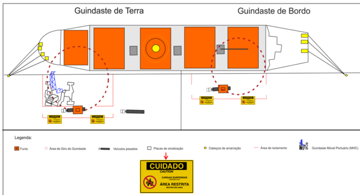
Figura 2 – Isolamento e sinalização de segurança das áreas de operação portuária.
