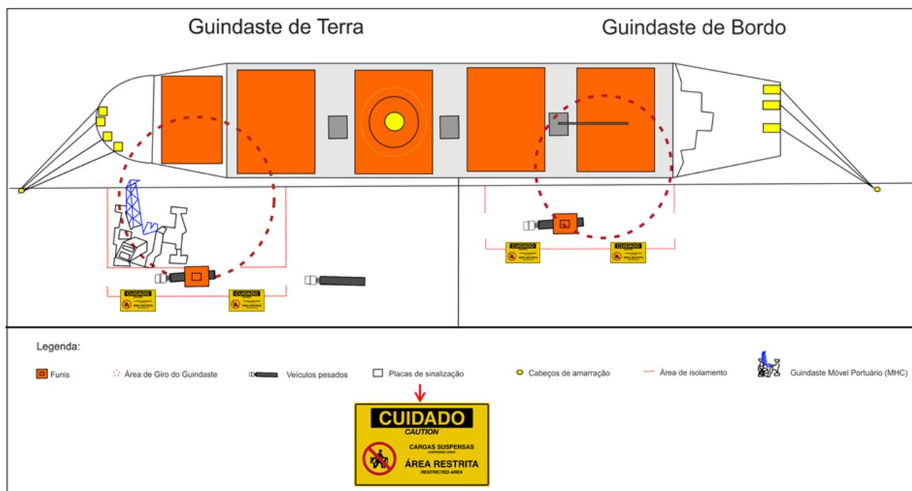
**Art. 556** Isolamento da área de trabalho deverá ser feito com cavaletes modulares ou grades, plásticas ou metálicas, de forma que criem uma barreira de acesso uniforme (sem espaços ou vãos).
